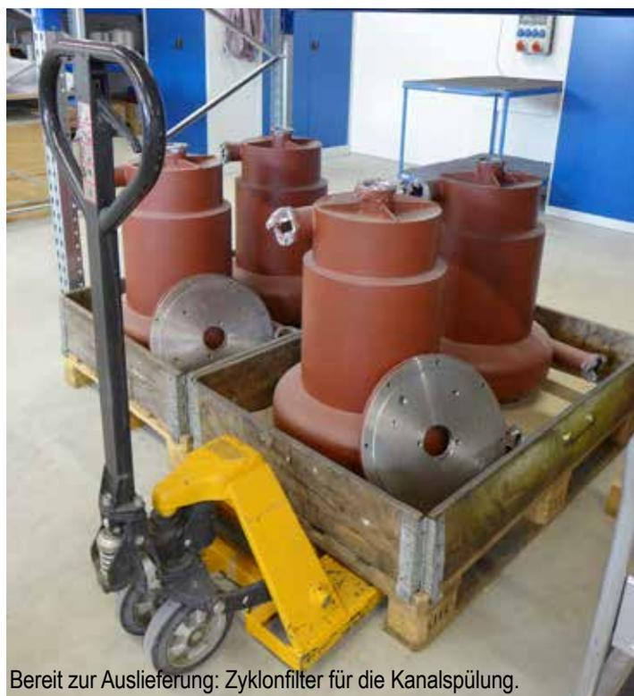
Bereit zur Auslieferung: Zyklonfilter für die Kanalspülung.
